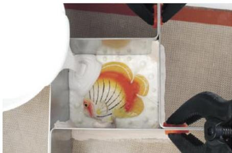
colare la seconda metà, sempre facendo attenzione di creare uno spessore adeguato di SILBIONE® RTV 4428 A+B sopra la parte più alta del soggetto;
