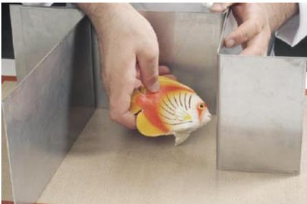
Posizionare il soggetto all'interno delle apposite pareti mobili, lasciando tutt'attorno uno spazio tale da permettere di ottenere una cornice che dia stabilità allo stampo e che permetta di avere una buona superficie dove creare gli incastri tra le due valve;
