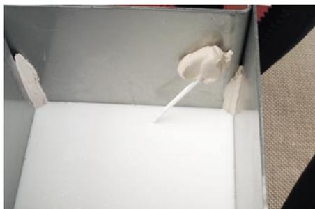
coprire la parte emersa del soggetto, creare un discreto spessore di SILBIONE® RTV 4428 A+B sopra alla parte più alta (almeno 1,5 cm), evitando così la formazione di parti troppo sottili e deboli;
