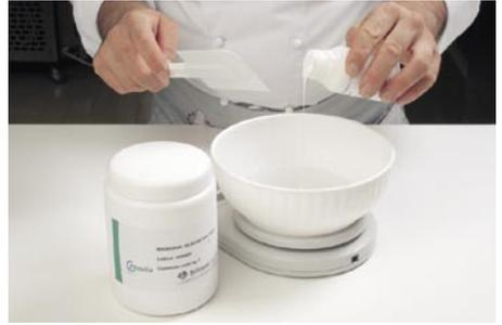
pesare con la massima precisione il catalizzatore SILBIONE® RTV 4428 parte B che dovrà essere pari al 10% del peso del SILBIONE® RTV 4428 parte A.
