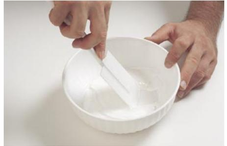
...fino ad ottenere un composto omogeneo. L'operazione di miscela dei componenti è molto importante, in quanto, se non ben effettuata, può compromettere il lavoro finito; in tal caso troveremo delle zone non catalizzate all'interno del nostro stampo che diverrà quindi inutilizzabile. La miscela così ottenuta va colata entro 30 minuti.
