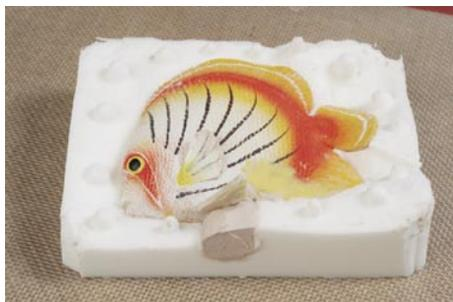
preparare la quantità di RTV sibilione 4428 A+B per colare la seconda valva lasciando il cilindro di plastilina che permette di ottenere il foro di riempimento;
