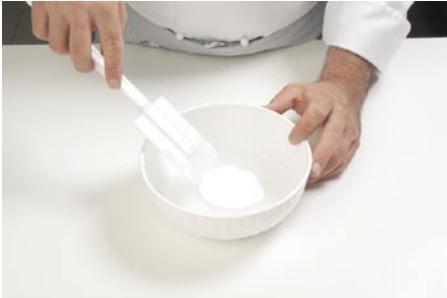
con l'utilizzo di una spatola in plastica\*, facendo attenzione a non incorporare aria, miscelare i due componenti...
