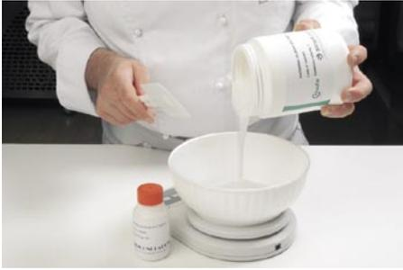
Valutare preventivamente la quantità di silicone necessaria alla creazione dello stampo, tenendo presente che per realizzare uno stampo alto 1 cm delle dimensioni di cm 10x10 si dovranno utilizzare pressappoco 100 g. di SILBIONE® RTV 4428 A e 10 g. di SILBIONE® RTV 4428 B. In un contenitore pesare la dose necessaria di parte A.
